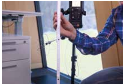
Abb. 9: Zweite Messung der Zugluft auf Tischhöhe (0,6 m).
