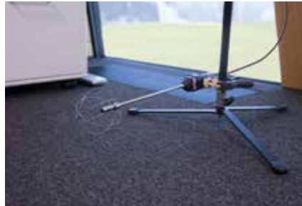
Abb. 8: Erste Messung der Zugluft auf 0,1 m Höhe am Boden.
