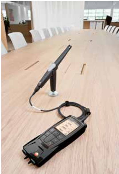
Abb. 13: Raumluftqualität messen mit testo 480.
