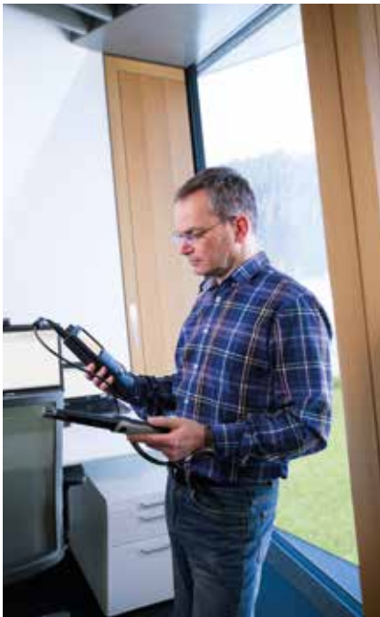
Abb. 3: Messen der Raumlufttemperatur und Raumluftfeuchte mit dem Klima-Messgerät testo 480.
